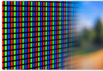
Bir ekranın çok yakından görünümü: her piksel kırmızı, yeşil ve mavi alt piksellerden oluşur
