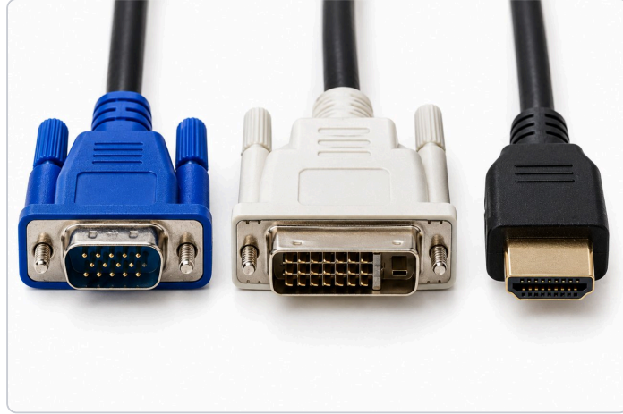
Görüntü kabloları (soldan sağa): D-SUB (VGA), DVI ve HDMI
